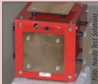
Feldsonde für das potentialfreie Messverfahren
