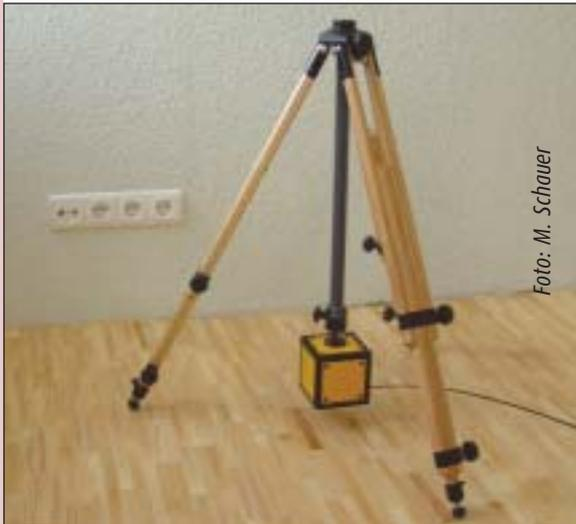
Mit Feldsonden ist es möglich, die Stärke eines niederfrequenten, elektrischen Wechselfeldes zu messen.
